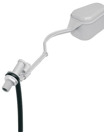
Le F12 de WIRQUIN est un robinet flotteur alimentation latérale utilisant un bras de levier pour fermer l'arrivée d'eau. La quantité d'eau dans le réservoir peut être réglée en fonction des deux niveaux disponibles. Son mécanisme simple n'exige aucun entretien et peut s'adapter à tout réservoir à alimentation latérale. Le F12 supporte les eaux calcaires et fonctionne avec une faible pression au niveau de l'arrivée d'eau.
