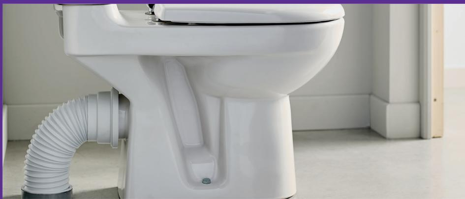
La pipe WC extensible convient pour les installations complexes, notamment pour les travaux de rénovation où la canalisation d'évacuation n'est pas accessible avec une pipe WC rigide. Le fil métallique à l'intérieur de la gaine garantit que cette dernière est à l'épreuve du temps. Ce produit est adapté pour les installations push-fit (à emboîter) ou à coller, en retirant le joint.
