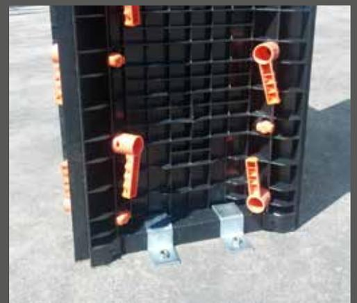
Le fixation au sol peut être effectuée en utilisant des listels de bois, des étriers ou des tirants. Ce mode de fixation permet d'annuler la levée éventuelle des panneaux.
