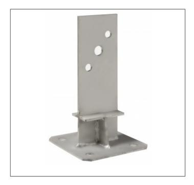
Les pieds de poteaux type PPSDTIX permettent la réalisation d'assemblages discrets et fiables. Leur conception en âme assure des charges au soulèvement. Les modèles inox sont en général recommandés dans les atmosphères corrosives mais dans des conditions très restrictives.
