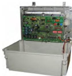
B. Débrancher secteur J2 et les cosses batteries J5A et J5B
